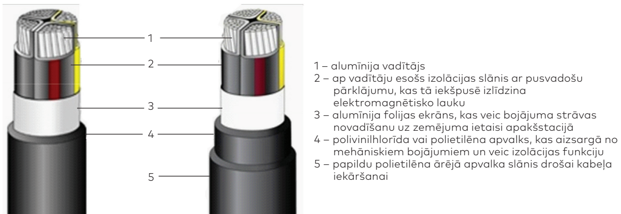
1.16. att. Četrzīslu zemsprieguma kabelis [7].
